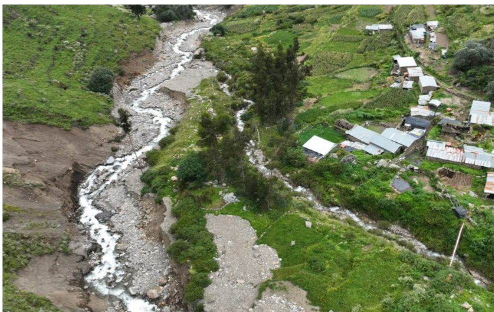
Fotografía N° 01: se puede apreciar el punto superior en la cual se observa la erosión del suelo que se ha venido colmatando generando la reducción del río.
