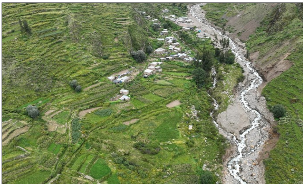
Fotografía N° 02: se puede apreciar el punto inferior en la cual se observa la erosión del suelo que se ha venido colmatando y reduciendo el ancho del río.
